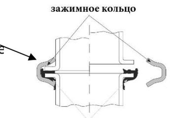
8. Поместите зажимное кольцо в открытом положении вокруг обжимных кромок соединяемых вместе частей трубы, прикрепите стяжку золотого/серебряного цвета, равномерно затяните оба зажимных винта до крутящего момента 10 Нм.
