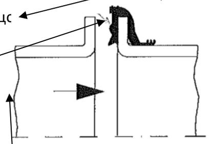
4. Противоположная труба должна находиться посередине соосно с фланцевой кромкой натянутого отбортовочного уплотнительного кольца.
